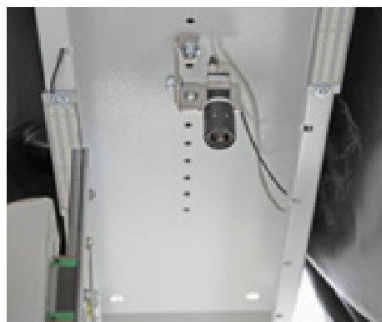
Camera voor de detectie van de hoek van de handdoek t.b.v. het DeepLearning-/ Vision-systeem
